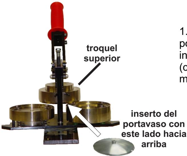
1. Antes de empezar el ensamblaje de los portavasos, primero usted tiene que meter el inserto del portavasos en el troquel superior (con el lado plano hacia abajo). El inserto es magnético y por eso se quedará.
