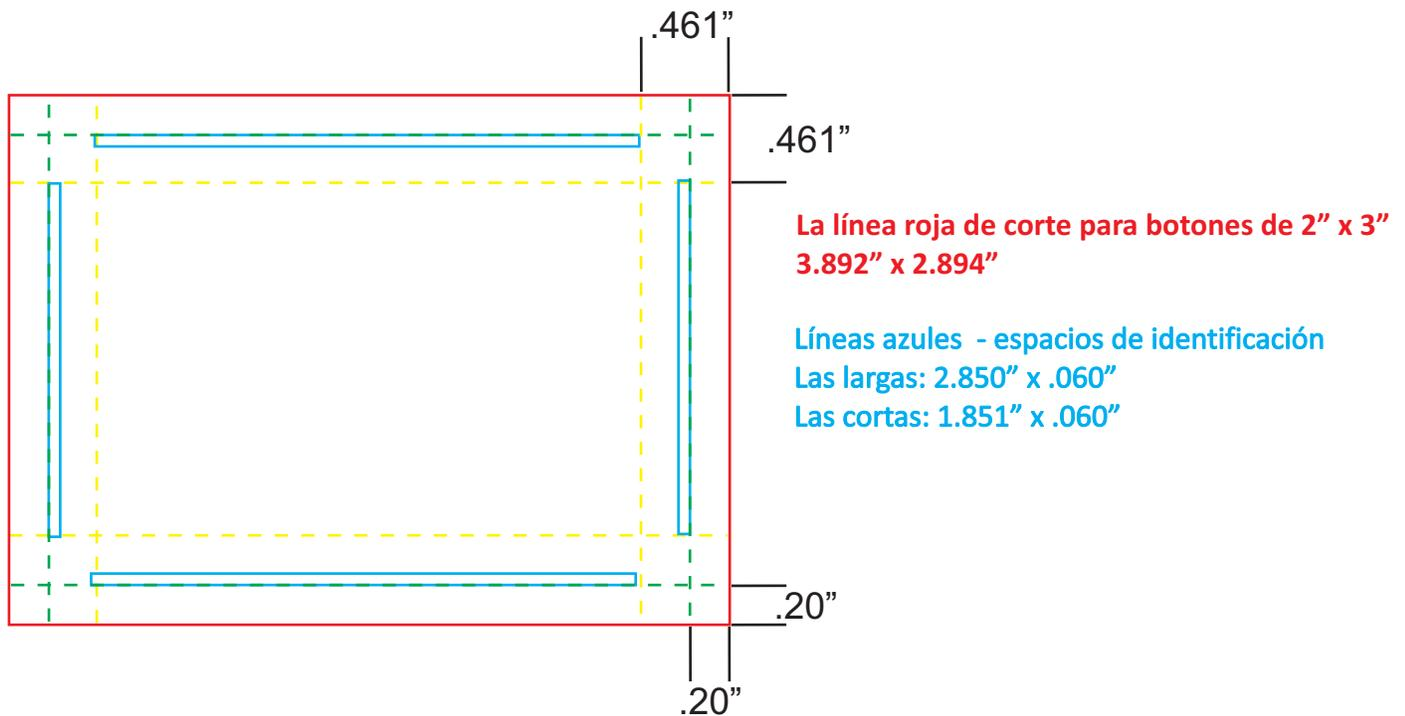
Depende del tipo de letra, se puede cambiar la medida de punto 5 hasta 8. Ajústelo para caber en el espacio de identificación.
